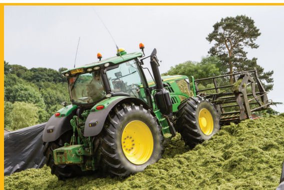
Figura 6.15: Shpërndajeni materialin në shtresa të holla, maksimalisht 10 cm, dhe më pas ushtroni tryzni mbi të para ngarkimit të radhës. Fotografi nga Dreamstime
